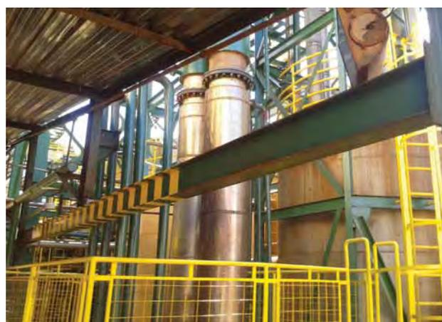
Coluna de sulfitação
