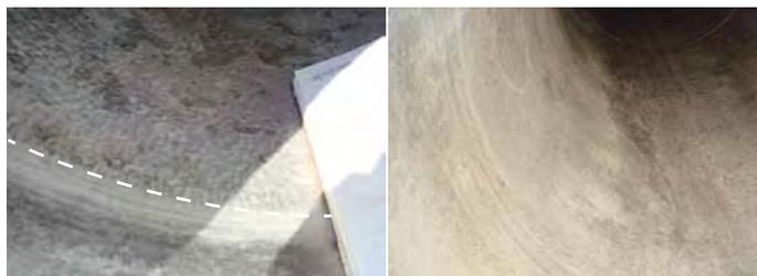
Figura 2 – vista detalhada do interior das colunas de sulfitação em 316L(E) e 317L(D)
