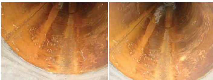
Figura 3 – vista detalhada do interior da coluna sulfitação em aço carbono
